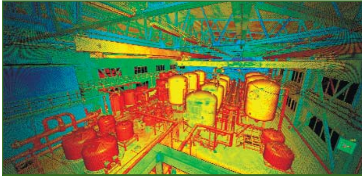
Рис. 2 Результаты сканирования оборудования станции водоподготовки
