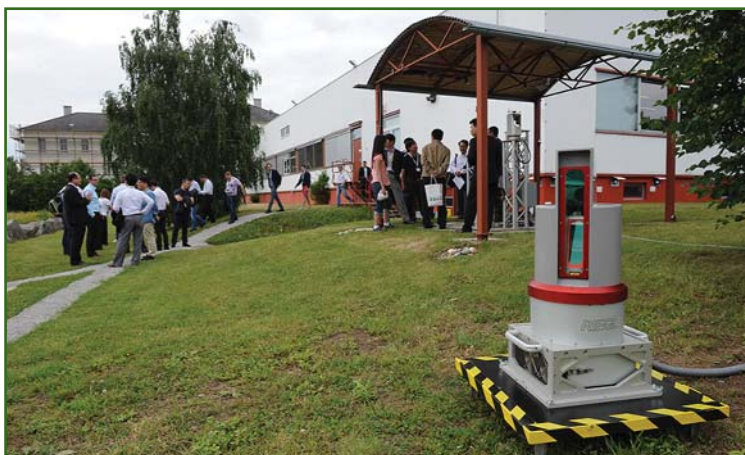
Испытания корпуса RIEGL PH для стационарного размещения сканеров RIEGL VZ-400/1000 (Хорн)
